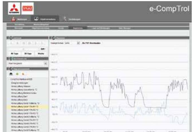
Die Verdampfertemperatur am Innengeräte-Wärmetauscher sinkt immer wieder unter 0 °C. Ist der Fühler defekt? Das wahre Problem zeigt sich in der Verlaufsgrafik von e-CompTrol: der Technikraum muss befeuchtet werden!
